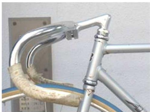
＜図8＞ルールに抵触しないようにステムを引き上げる
