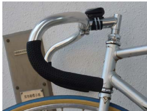
<図10>ハンドルとステムを交換した例 レース中は選手が見える位置に スピードメータ等の装着は不可
