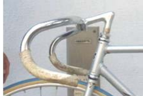
<図10>ハンドルとステムを交換した例 レース中は選手が見える位置に スピードメータ等の装着は不可
