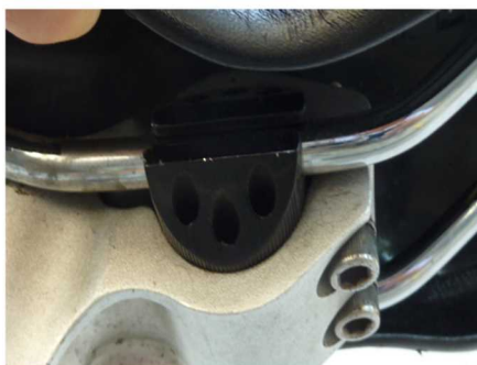
＜図6＞ロード用に交換されたシートピラーの例
